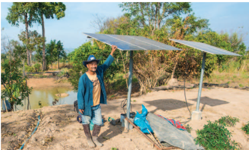
แผงโซลาร์เซลล์เชื่อมต่อกับเครื่องสูบน้ำเข้าแปลงเกษตร
