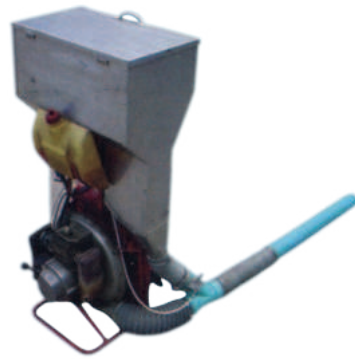
เครื่องฟ่นหว่านเมล็ดข้าวและปุ๋ยเม็ด ดัดแปลงจากเครื่องฟ่นสารเคมี ช่วยลด ปัญหาขาดแคลนแรงงาน และการใช้ เมล็ดพันธุ์สิ้นเปลือง
