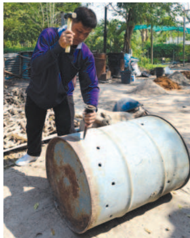
7 เจาะให้รอบถัง ครบ 16 รูด้านข้าง และ 4 รูด้านบน
