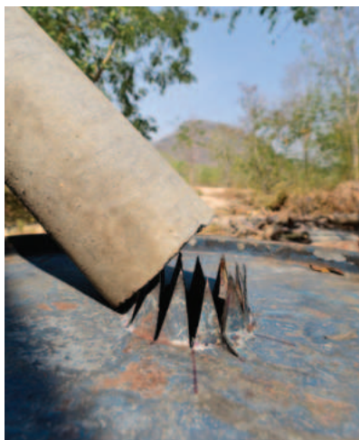
7 ลองนำท่อไยหินขนาด 6 นิ้ว มาสวมให้พอดี เป็นปล่องระบายควัน แล้วดึงออก พักไว้
