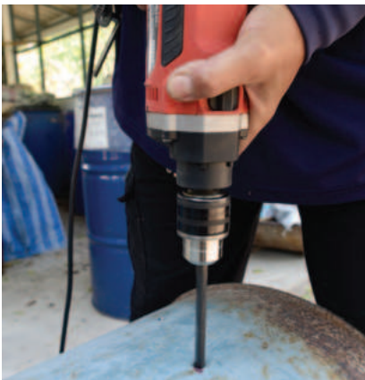
5 จากนั้นใช้สว่านไฟฟ้าช่วยเจาะ (ถ้ามี)
