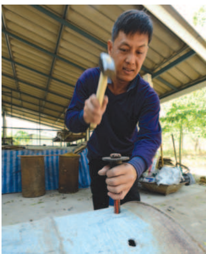
6 ใช้ค้อนตอกเหล็กสกัด เปิดให้รูกว้าง 1.50-2 เซนติเมตร
